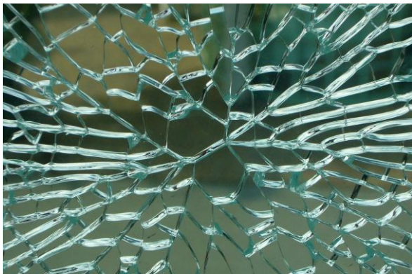
Abbildung 3: Bruchbild ESG mit Schmetterlingsstruktur
